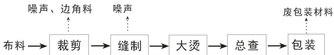
图 4.2-1 新达服装厂生产工艺流程
